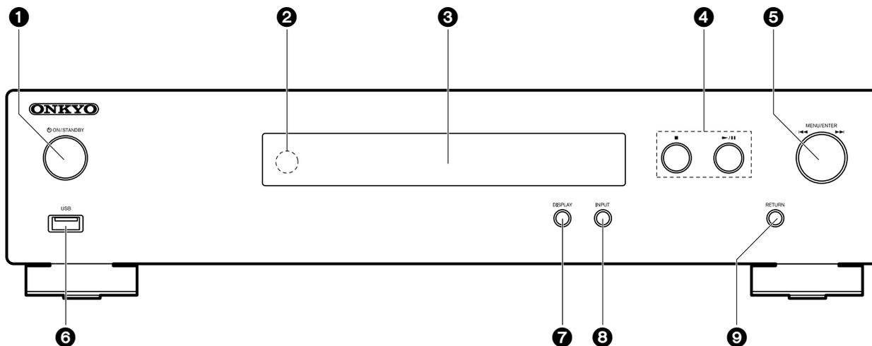
1. Кнопка **ON/STANDBY**: Предназначена для включения устройства или переключения его в режим ожидания.
