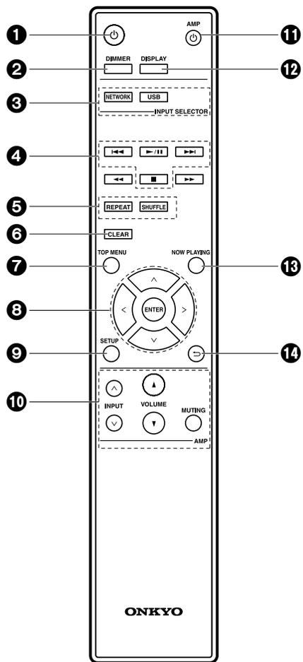
1. Кнопка : Предназначена для включения устройства или переключения его в режим ожидания.
