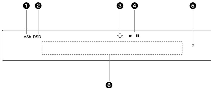
1. ASb: Горит при установке параметра «Auto Standby» (Автоматическое переключение в режим ожидания) (➔ Стр. 24) в значение «On»(Вкл.).
