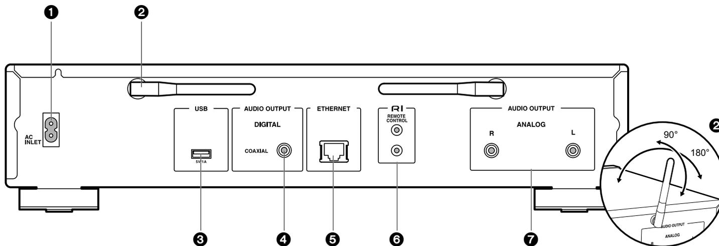
1. Вход кабеля питания AC INLET: Используется для подключения входящего в комплект кабеля питания.
