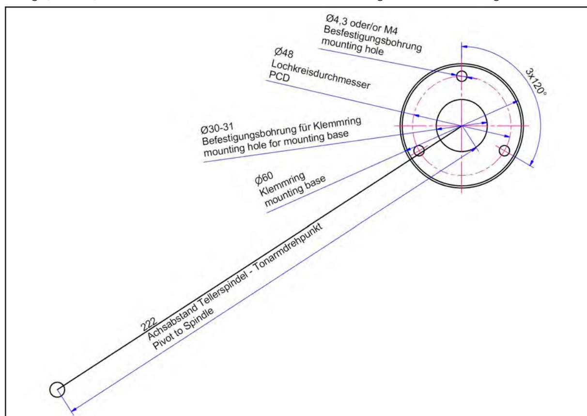
Abb. 2: Abmessungen zur Montage des Klemmrings bei Fremdlaufwerken
