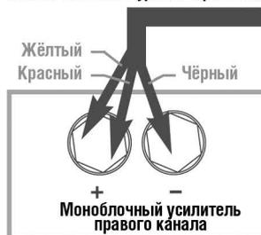
Если используется усилитель симметричной конструкции, следуйте указаниям в разделе, описывающем подключение к дифференциальному усилителю.
