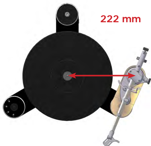
Abb. 5a: Abstand der Spindel zum Drehpunkt/ Universal 9" = 222 mm
