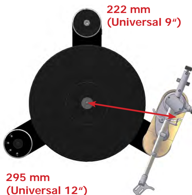
Abb. 8: Abstand Laufwerksspindel zum Tonarm
