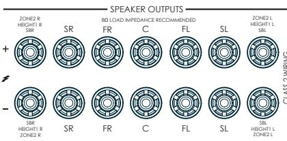
Важно, чтобы отдельные жилы провода из этих соединений не касались другого кабеля или корпуса устройства. Невыполнение этой инструкции может привести к короткому замыканию и повреждению ресивера.
