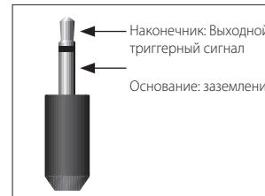
Триггерные разъемы (**TRIG Z1** и **TRIG Z2**) подают электрический сигнал, когда ресивер включен, а также когда активированы соответствующие зоны.
