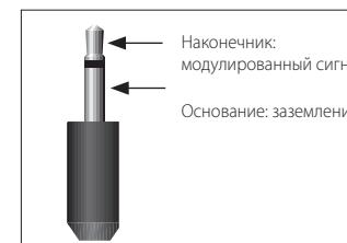
Инфракрасные входные разъемы (**Z1 IR** и **Z2 IR**) позволяют подключать внешние ИК-приемники, когда ИК-приемник на передней панели ресивера полностью или частично закрыт, а также для использования пульта дистанционного управления в Зона 2.
