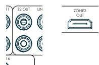
Выходной разъем HDMI Z2 может использоваться для подключения выходного разъема ресивера к системе, расположенной во втором помещении.
