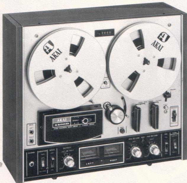
Dieses formschöne Tonbandgerät bietet viele Möglichkeiten und kann im Senkrechtbetrieb mit transparenter Plexiglasabdeckung betrieben werden, eingebaute Spulenhalter, Multiplayback, Hinterbandkontrolle, Bandwählschalter, Mischmöglichkeit und automatische Endabschaltung.
