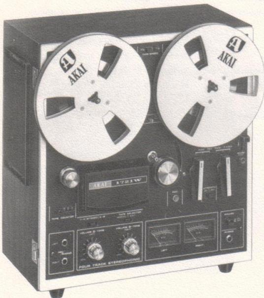
Diese Kompaktmaschine bietet viele Möglichkeiten. Anschluß für ein magnetisches Tonabnehmersystem, eingebauter Verstärker und Lautsprecher. Das Gerät kann auch als Wiedergabeverstärker ohne Tonbandbetrieb geschaltet werden. Drei Geschwindigkeiten und automatische Endabschaltung.
