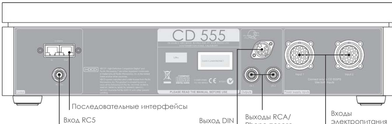
**Примечание:** Запрещается одновременное использование выходных розеток RCA/Phono и DIN.
