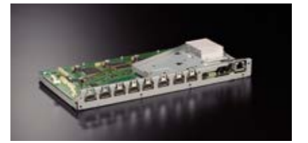
一体成型メタルフレーム・デジタル系回路基板
