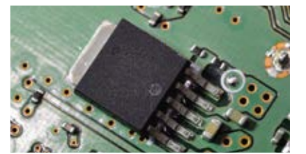
デジタル回路用のアナログ定電圧レギュレーター
