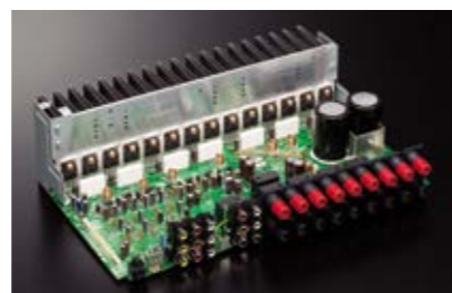
STR-DN1080に搭載されたリニア広帯域パワーアンプ
