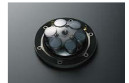
6つのマグネットを同心円状に配置し、背圧のストレスを排除したトゥイーターユニット(SS-AR1/AR2共通)
