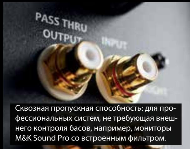
Сквозная пропускная способность: для профессиональных систем, не требующая внешнего контроля басов, например, мониторы M&K Sound Pro со встроенным фильтром.
