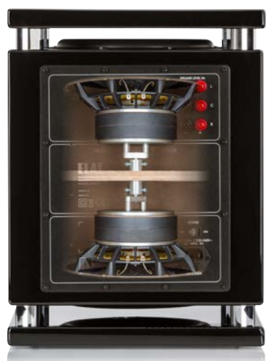
← Система Push-Pull SUB 2070 в разрезе
