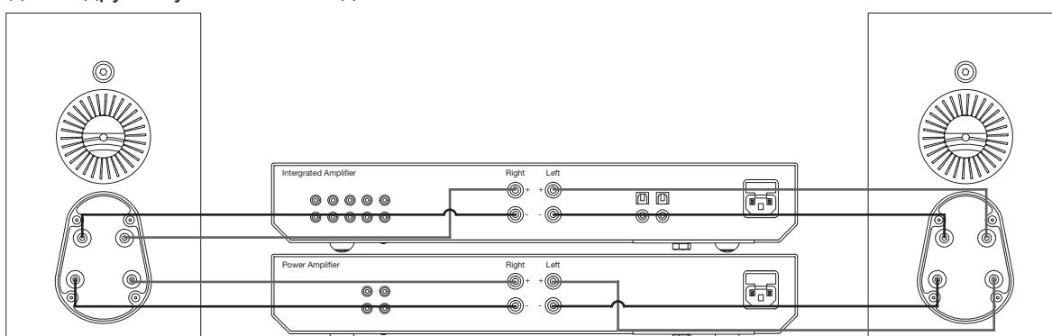
**⚠ ПРИМЕЧАНИЕ:** Перемычки между клеммами необходимо снять.
