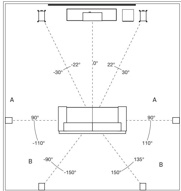
Колонку центрального канала Silver C250 следует установить так, чтобы она была направлена на зрителя и находилась примерно на уровне его головы.
