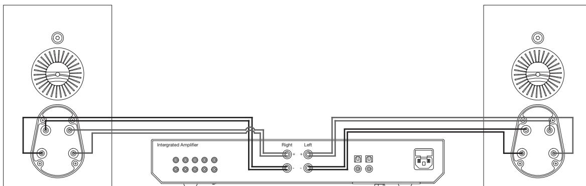
**⚠ ПРИМЕЧАНИЕ:** Перемычки между клеммами необходимо снять.
