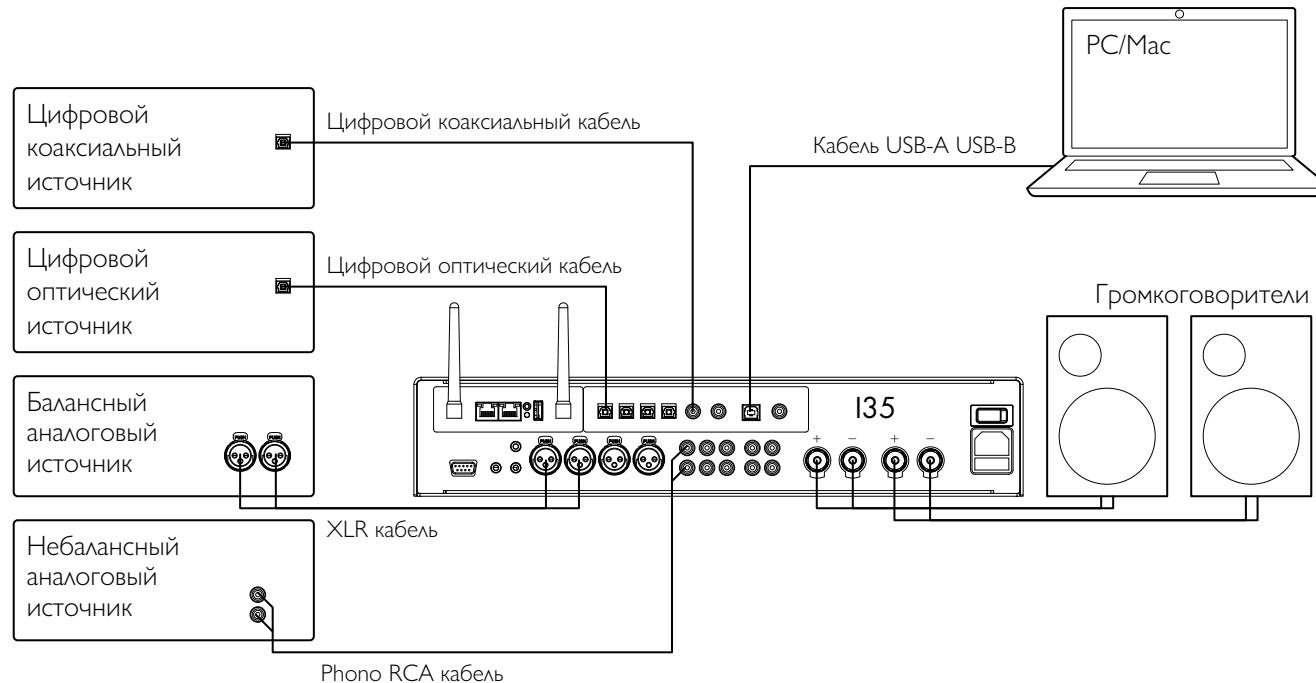
Эти способы воспроизведения музыки предусматривают подключение источника к I35 с помощью кабеля и не требуют Wi-Fi, Ethernet или Bluetooth.
