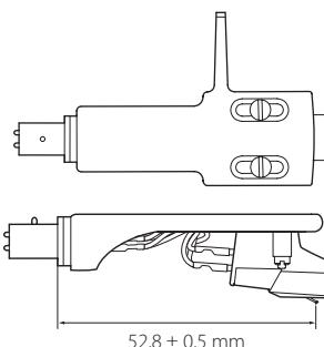
**4 Sluit de aansluitingen van de elementhouder aan op het element.**
