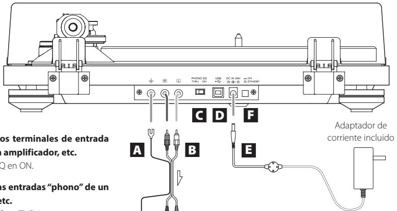
Se conecta a los terminales de entrada de audio de un amplificador, etc.
