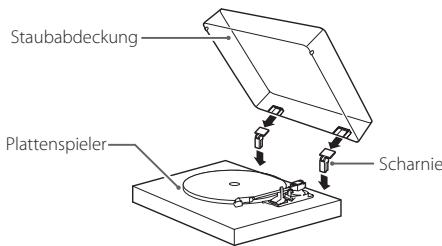
**1 Führen Sie die Scharniere vollständig in die linke und rechte Scharnieröffnung auf der Rückseite des Plattenspielers ein.**
