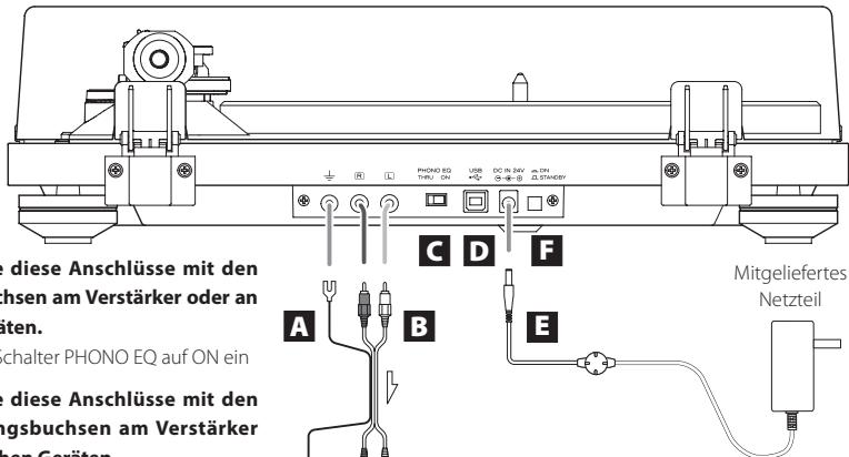
**Verbinden Sie diese Anschlüsse mit den Line-Audiobuchsen am Verstärker oder an ähnlichen Geräten.**
