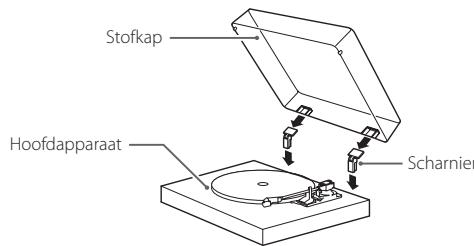
**1 Steek de scharnieren volledig in de scharnierhouders aan de linker en rechter achterkant van het hoofdapparaat.**
