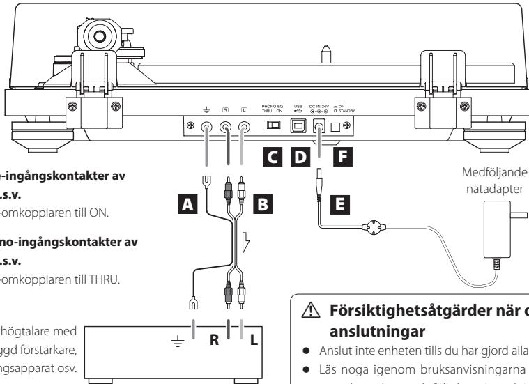
**Anslut till linje-ingångskontakter av förstärkaren o.s.v.**
