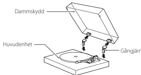
**1 Sätt gångjärn komplett i gångjärnhållarna på vänster och höger slut av huvudenhetens baksida.**
