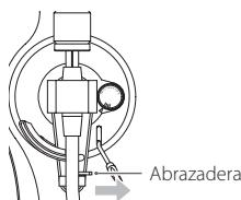
**3 Levante la palanca elevadora del brazo y desplace el brazo ligeramente hacia la izquierda.**
