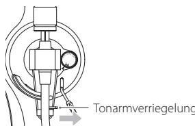
**3 Heben Sie den Lifthebel an und schieben Sie den Tonarm dann ein Stück nach links.**
