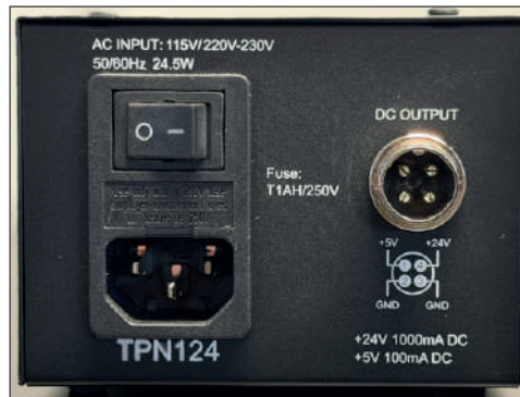
Fig. 18 Anschluss des Linearnetzteils TPN 124
