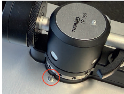
Fig. 24 Justageschraube für die Endabschaltung
