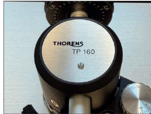
Fig. 8 installiertes Gegengewicht mit Skala für die Auflagekraft (Wert 2) und Einstellrad für das magnetische Antiskating.
