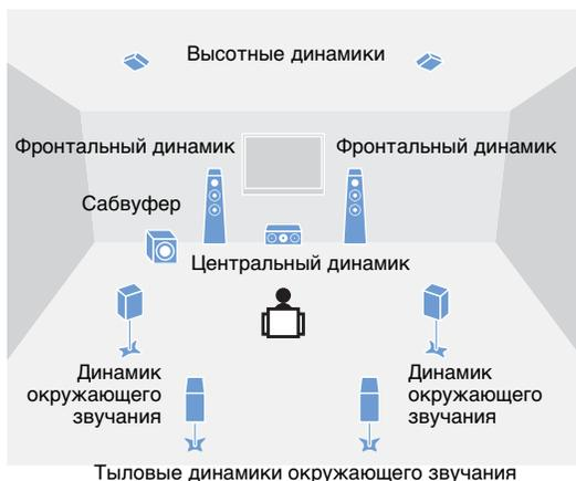
В высшей степени реалистичное акустическое поле может быть создано с помощью нескольких динамиков, установленных вокруг слушателя, как показано на иллюстрации выше. Однако установить такую систему в жилом помещении может быть сложно. В данном аппарате используется технология «цифровой звуковой проектор», которая позволяет с помощью одного устройства создать реалистичное и естественное ощущение окружающего звучания.
