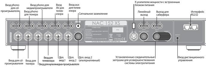
Входы для сd-проигрывателя, тюнера, мултимедиа-проигрывателя, телевизора и доп. входы
