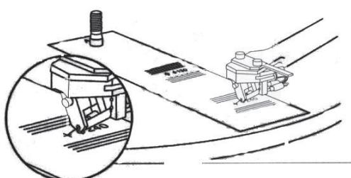
**Регулировка вертикального угла воспроизведения (VTA):** Вертикальный угол воспроизведения для установленного звукоснимателя Goldring Eroica LX должен быть отрегулирован изготавителем. Для того чтобы отрегулировать VTA для других звукоснимателей, положите на опорный диск виниловую пластинку (5). Ослабьте горизонтальные регулировочные винты (два **винта** с шестигранной головкой, расположенные рядом с пластиной основания на задней стороне стойки тонарма) прилагаемым шестигранным ключом.
