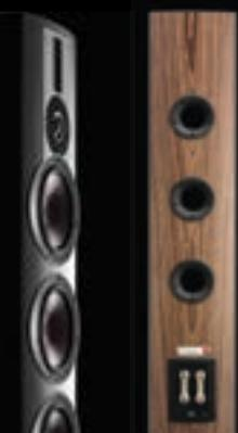
Изготовленные из плит MDF (Medium Density Fibre), корпуса колонок серии RUBICON образуют прочную базу для динамиков, которые привинчены болтами прямо к фронтальной панели толщиной 25 мм. Чтобы обеспечить интеграцию с корпусом, пять отверстий для болтов расположены прямо напротив ребер корзины НЧ-динамика. Модуль твитераочно фиксируется на месте с помощью четырех болтов, устраняющих вибрации и резонансы.
