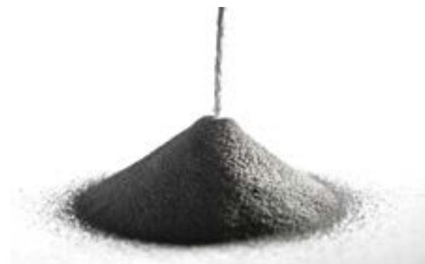
Индивидуальное покрытие каждой магнитной гранулы делает возможным спекание сильного магнита, который не проводит электрический ток.
