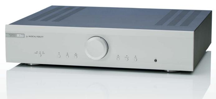
M3Si выполнен по схеме «двойное моно», которая обеспечивает идентичность характеристик левого и правого каналов. Использование в конструкции аппарата эксклюзивных комплектующих элементов, позволило уменьшить длину печатных проводников. Это позволило снизить погонную емкость и индуктивность, а также дало возможность расширить полосу воспроизводимых частот и динамический диапазон.
