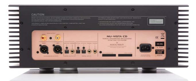
Плеер оборудован двумя независимыми цифровыми коаксиальными и оптическими входами. На коммутационной панели также смонтированы цифровой коаксиальный и оптический выходные порты. Для подключения к усилителю Nu-Vista CD Player оборудован симметричными (XLR) и несимметричными (RCA) терминалами. В комплект поставки входит ИК пульт дистанционного управления.
