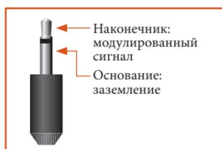
Инфракрасные входные разъемы (Z1 IR и Z2 IR) позволяют подключать внешние ИК-приемники, когда ИК-приемник на передней панели ресивера AVR полностью или частично закрыт или для использования пульта дистанционного управления в Зоне 2.
