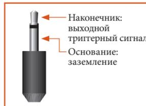
Триггерные разъемы (TRIG Z1 и TRIG Z2) подают электрический сигнал, когда ресивер AVR включен, а также когда включены соответствующие зоны.
