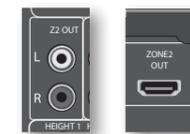
Разъем HDMI Z2 out может использоваться для подключения выходного разъема ресивера AVR к системе, расположенной во втором помещении.
