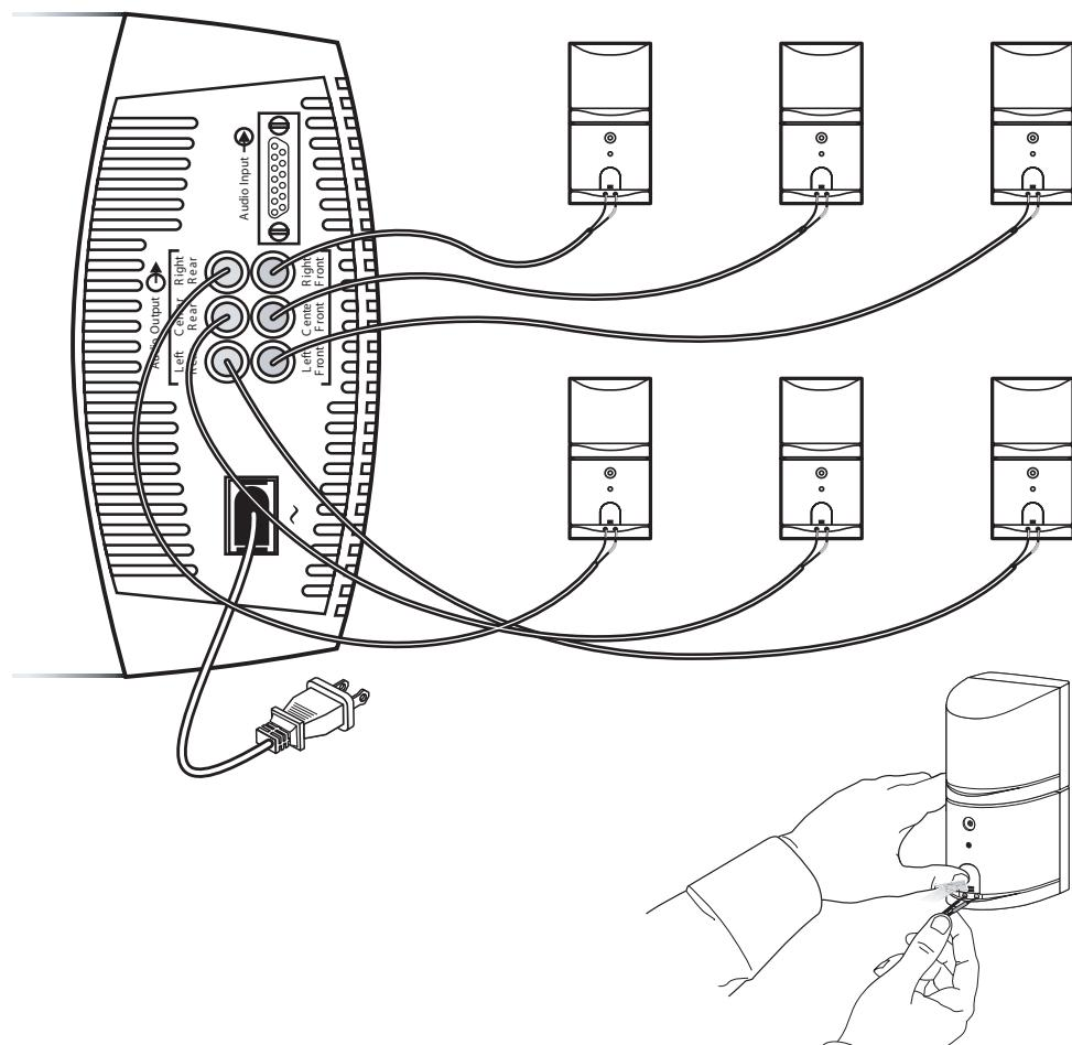
1. Подключите проводной вывод шнура, маркированный **CENTER** к центральной колонке. Нажмите на кнопку клеммы позади колонки и вставьте маркированный провод (+) в красную клемму, а одноцветный провод (-) в черную клемму. Отпустите кнопку, чтобы зафиксировать провода.
