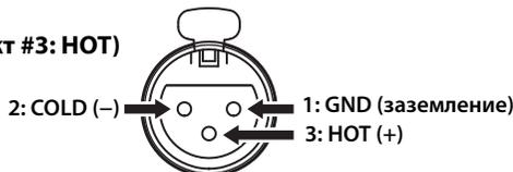
Обратитесь к руководству по подключенному компоненту, чтобы узнать положение контакта HOT в симметричных выходных гнездах компонента.
