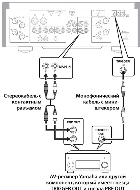
AV-ресивер Yamaha или другой компонент, который имеет гнезда TRIGGER OUT и гнезда PRE OUT
