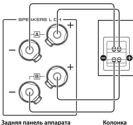
**3 Установите селектор SPEAKERS на передней панели в положение A+B BI-WIRING.**
