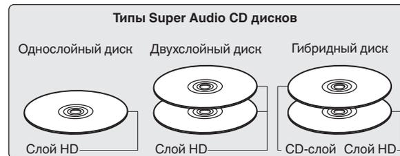
HD-слой — слой диска Super Audio CD с высокой плотностью записи сигналов.
