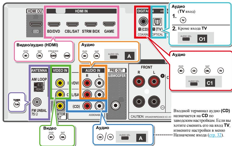
Входной терминал аудио (CD) назначается на CD по заводским настройкам. Если вы хотите сменить его на вход TV, измените настройки в меню Назначения входов (стр. 32).
