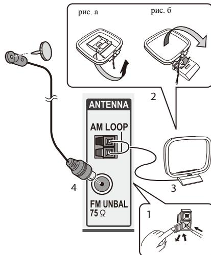
**1** Откройте защитные выступы, вставьте по одному проводу в каждый разъем до конца, затем отпустите выступы для фиксации проводов антенны AM.
