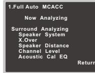
В процессе вывода ресивером дополнительных тестовых тонов, предназначенных для определения оптимальных настроек уровня канала, расстояния до АС и Acoustic Calibration EQ, на экране отображается отчет о ходе выполнения процесса.
