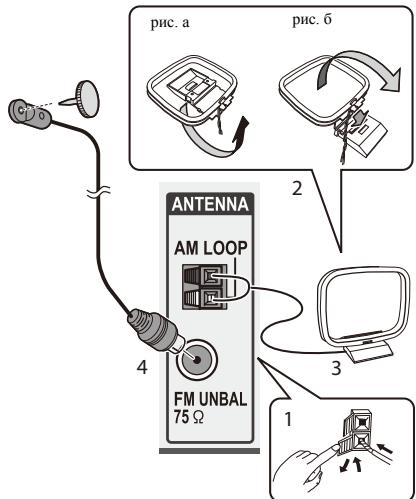
**1** Откройте защитные выступы, вставьте по одному проводу в каждый разъем до конца, затем отпустите выступы для фиксации проводов antennы AM.
