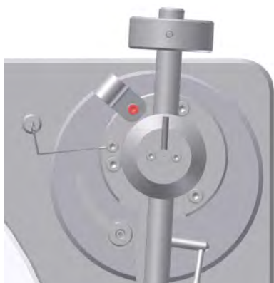
Bild 3: Befestigung der Kabelführung an der Tonarmbasis
