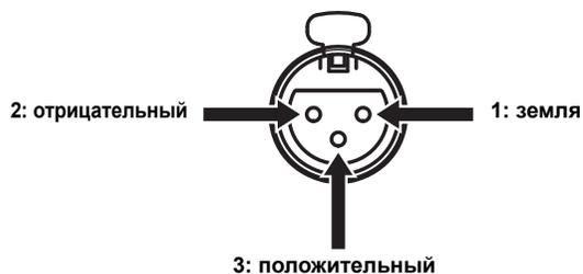
См. инструкцию по эксплуатации, прилагаемую к подключенному компоненту, и проверьте назначение положительного контакта соответствующих сбалансированных выходных гнезд XLR.
