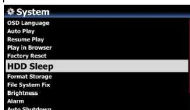
※Для того, чтобы X35 проснулся из режима ожидания жесткого диска, требуется 3 ~ 4 секунды. В течение этого времени реакция X35 на входной сигнал с пульта дистанционного управления будет задерживаться.
