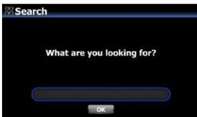
Вы можете искать радиостанцию в Интернет-радио: на экране Интернет-радио нажмите кнопку SEARCH на пульте дистанционного управления, затем отобразится левый экран. Введите первые несколько алфавитных символов станции и нажмите «ОК». Аналогичные станции также отображаются.
