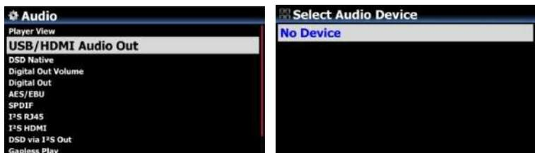
Если к USB аудиовыходу X35 подключено аудиоустройство USB ЦАП или HDMI, подключенные устройства будут перечислены здесь. Вы можете выбрать его здесь.
