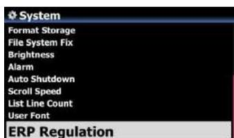
В соответствии с Регламентом CE (ErP / Energy Efficiency Regulation), X35 автоматически переходит в режим выключения питания или WOL через 20 минут без какого-либо рабочего или входного сигнала. Вы можете установить эту функцию как ВКЛ или ВЫКЛ
