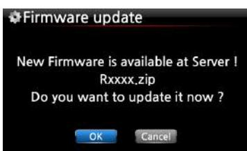
※ПРИМЕЧАНИЕ. Если выбрать ОТМЕНА, папка [New Firmware] создается автоматически на внутреннем жестком диске (или USB), тогда X35 не будет запрашивать обновление прошивки при загрузке. Если вы удалите [New Firmware] через браузер, он снова спросит.
