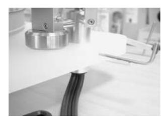
Когда тонарм закреплен, вы можете подсоединить звукосниматель к тонарму. Направляющая в головке звукоснимателя упрощает сборку. Пожалуйста, закрепите звукосниматель при помощи винта и соответствующего шестигранного ключа, когда звукосниматель расположен на нижнем порожке (см. рисунок). В этом положении звукосниматель и тонарм будут автоматически иметь правильный угол и оптимизированный наклон.
