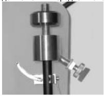
Точная настройка может быть выполнена наилучшим образом, когда проигрывается хорошо известная запись, которая должна содержать сольную партию инструмента или голоса спереди центра звуковой сцены. Если звуковой образ больше смещен вправо, вы должны уменьшать антискейтинг, выворачивая винт настройки. Если звуковой образ больше смещен влево, вы должны увеличивать антискейтинг, заворачивая винт настройки.
