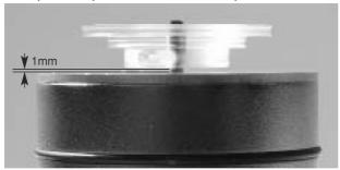
Поднимите шасси проигрывателя и вдвиньте двигатель снизу точно под отверстием с заданным в шасси положением. Пожалуйста, уделите внимание тому, чтобы переключатель двигателя оказался снаружи, с левой стороны корпуса проигрывателя грампластинок. Когда двигатель окажется в правильном положении, осторожно опустите шасси.
