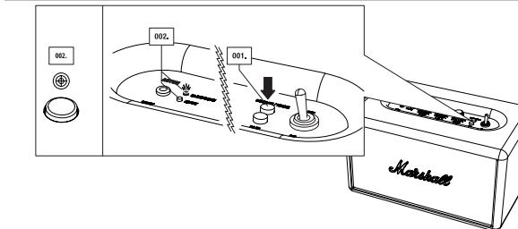
001. НАЖМИТЕ КНОПКУ ИСТОЧНИК/АКТИВАЦИЯ для выбора источника и/или переключения между подключенными источниками.
